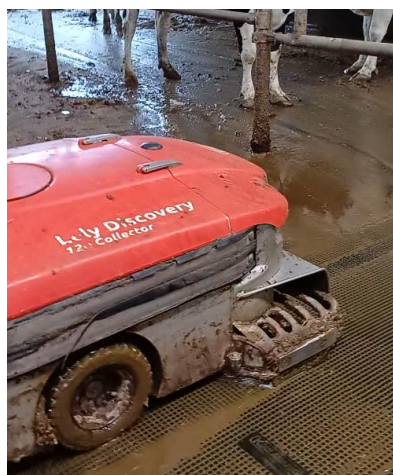
1 pav. Robotas takuose surenka mėšlą ir išpurškia probiotikus
