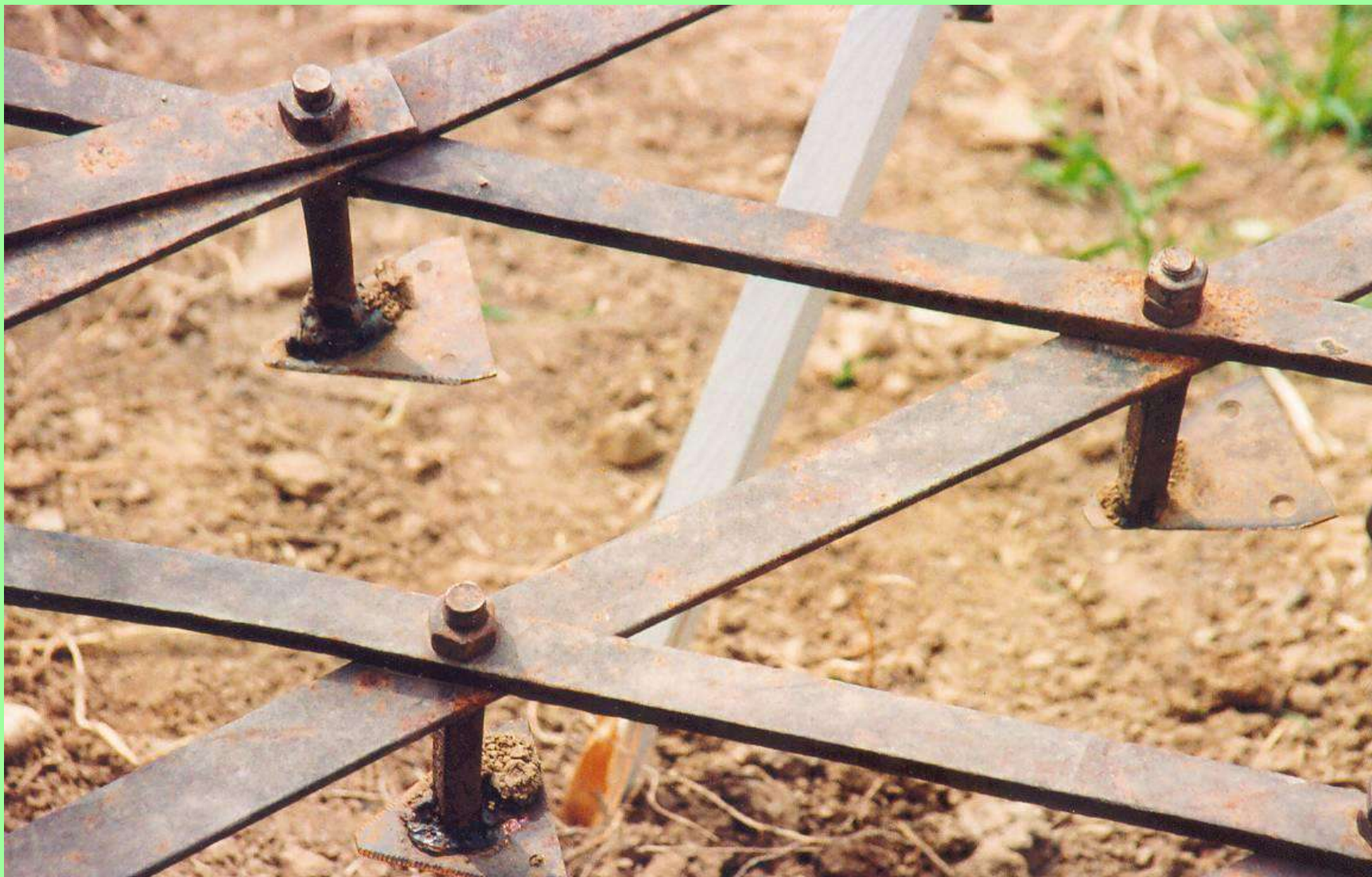
13 pav. VDU ŽŪA Bandymų stotyje pagamintos lanksčios leteninės akėčios
