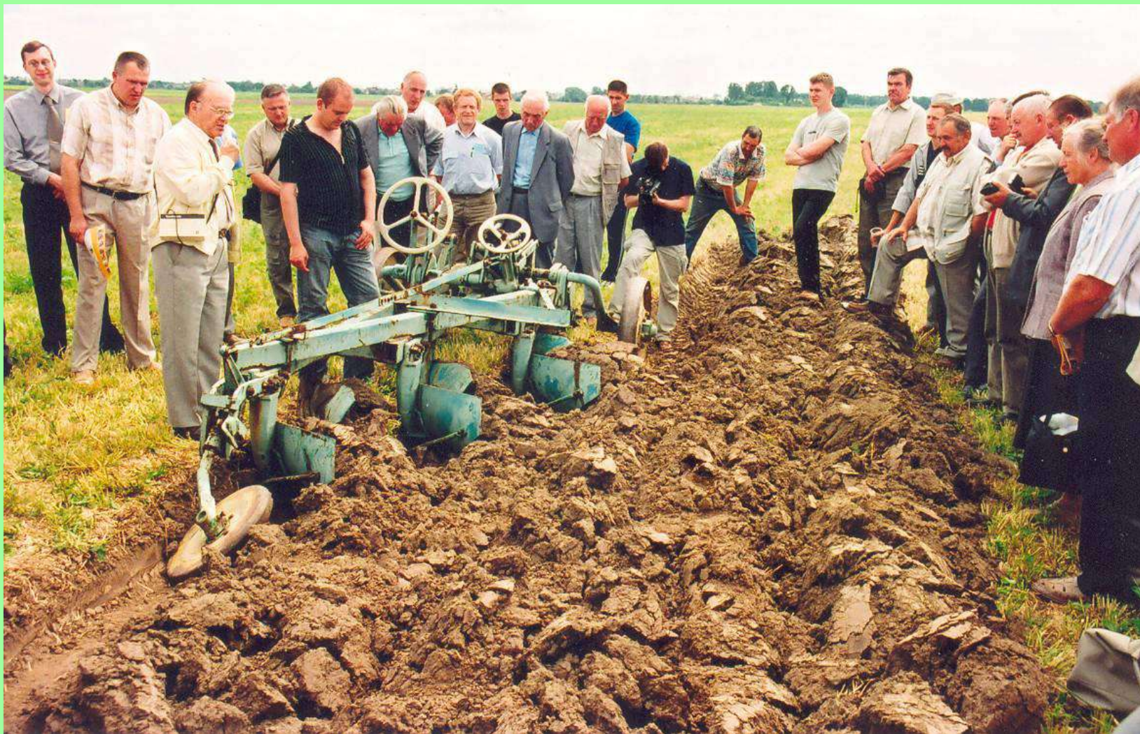
10 pav. Standartinis prikabinamas dvisluoksnis plūgas VDU ŽŪA Bandymų stotyje
