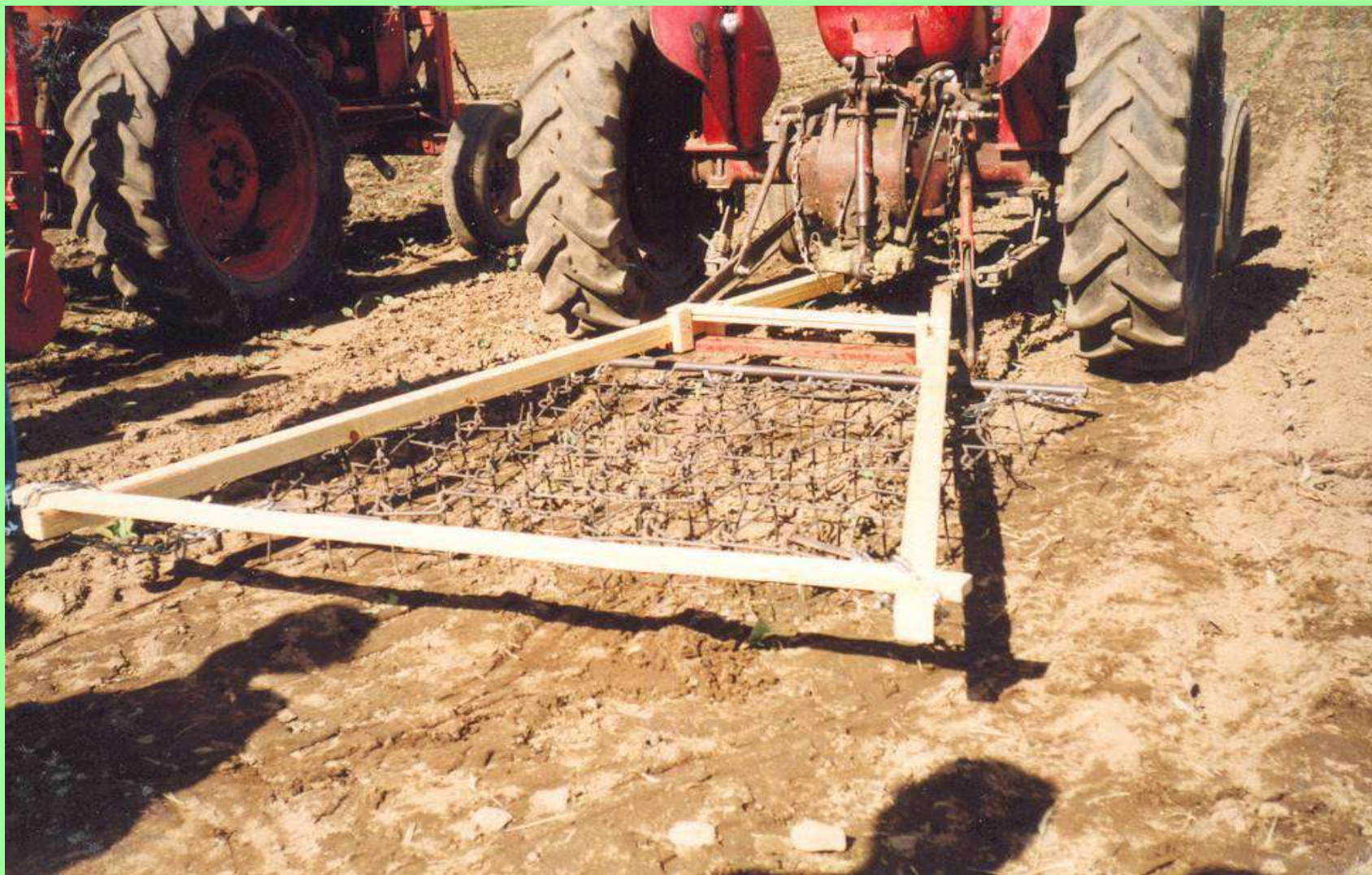
14 pav. Suomių pritaikytos pakabinamos tinklinės akėčios pasėlių akėjimui
