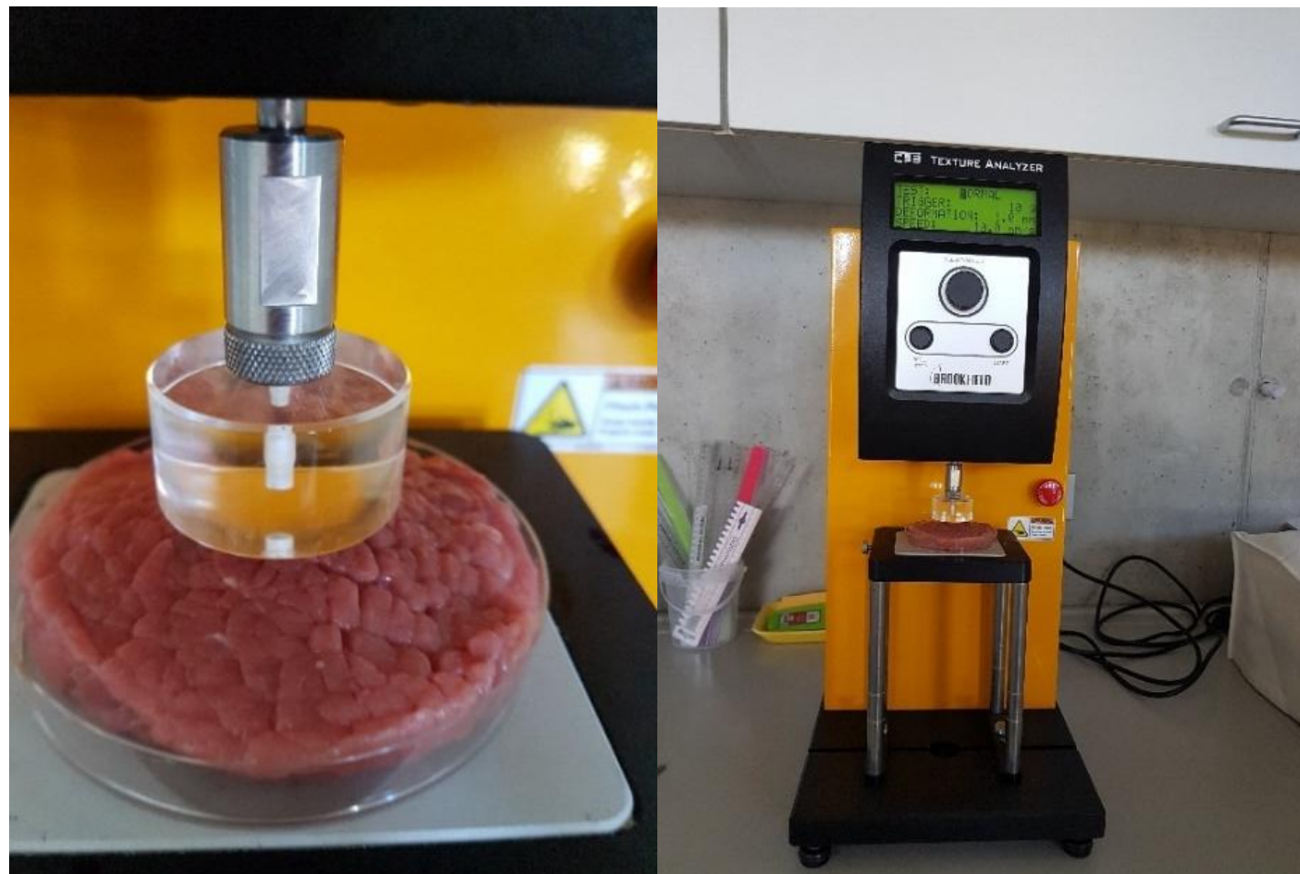
Paveikslas 2.3.10. Mėsos kietumo vertinimas tekstūrografu.
