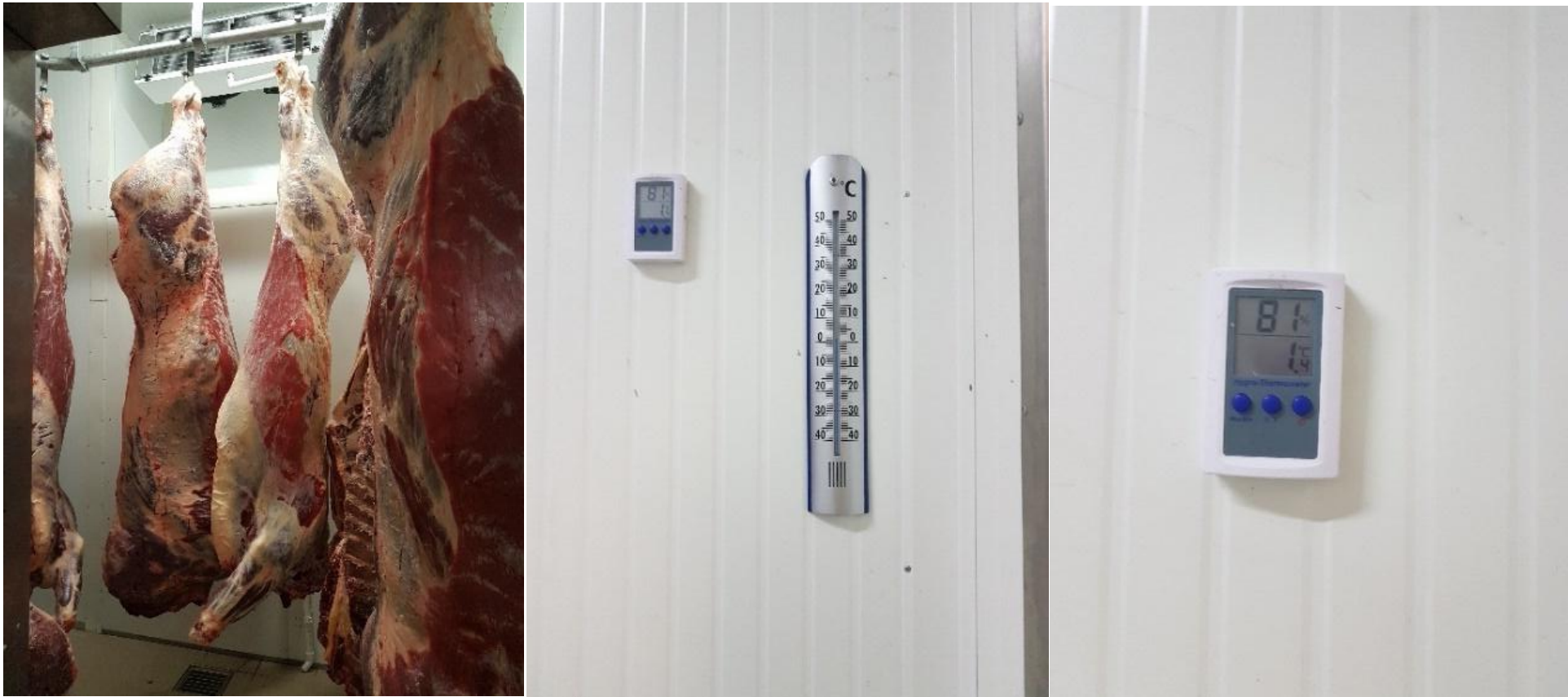
Paveikslas 2.3.11. Tinkama atvėsavimo temperatūros kontrolė (termometras su patikra, nepasitikėti elektroniniu drėgnomačiu ar higrometru), skerdenų pakabinimas, paliekant tarpus tarp skerdenų, kad būtų išvengta susilietimo ir sušutimo (Partnerio 2 skerdykloje).
