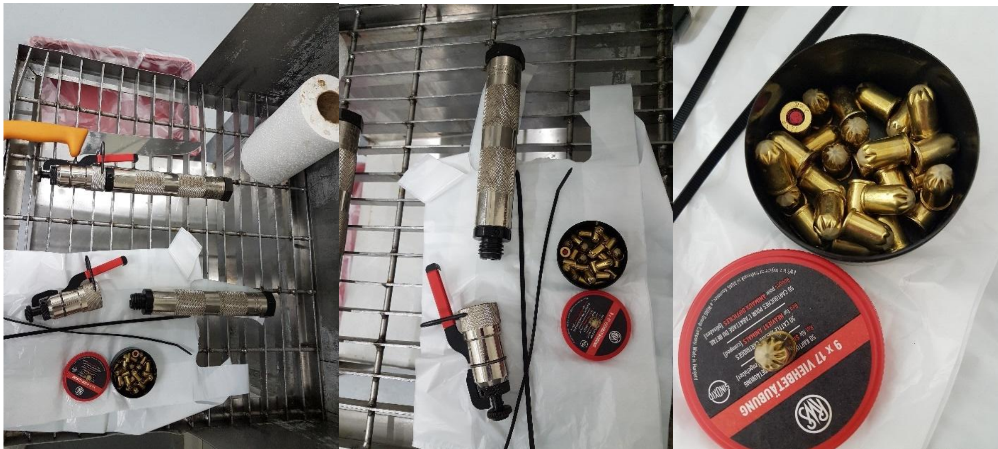
Paveikslas 2.3.12. Svaiginimo pistoleto patikra, atsarginis pistoletas ir tinkamo dydžio šratų parinkimas, užtikrinant nepriekaištingą gyvūnų gerovę skerdykloje (Partneris Nr. 4).
