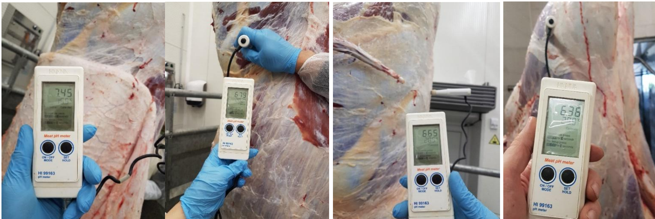
Paveikslas 2.3.9. Šiltos mėsos pH kontrolė matuojant smeigiamuoju pH-metru skirtingose išorinio kumpio vietose: lupant odą, 1 val. po skerdimo, 2 val. po skerdimo, 4 val. po skerdimo.
